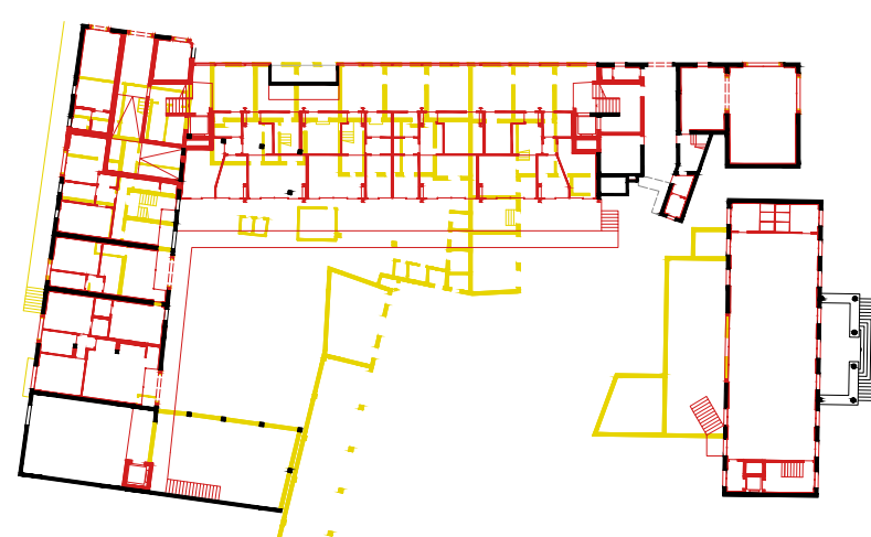
Pianta quota 1.50, demolizioni/costruzioni, sc. 1:750
